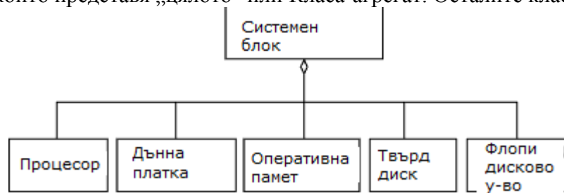
фигура 16. Диаграма на класовете за илюстрация на отношение „агрегация“ – пример „Системен Блок на ПК“
